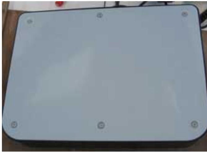
Le stick s'ouvre facilement en retirant les 6 vis situées en dessous. Il faut bien entendu auparavant faire sauter les 4 pieds en plastique, un coup de tournevis et c'est réglé. Plus qu'à ôter la plaque métallique (qui au passage constitue les 4/5 du poids du stick).
