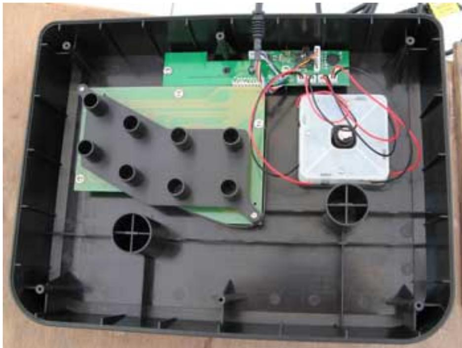
Une fois ouvert, on se retrouve avec un truc relativement bien rangé. A droite, le stick, à gauche, le circuit imprimé sous les boutons, qu'il faudra complètement virer, on n'en a pas besoin. Tout en haut, le PCB.
